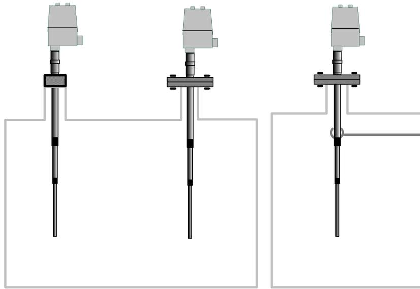
管座安装和法兰安装
