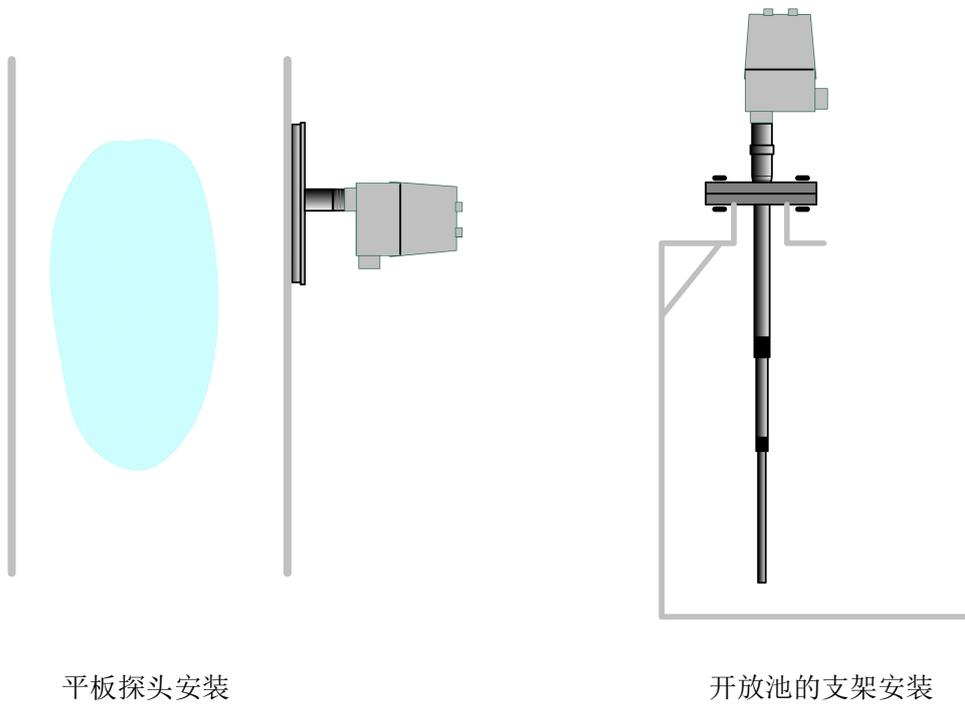
图 2.2 典型安装示意图
