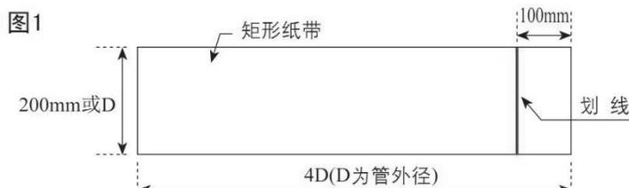
2. 将定位纸缠绕在表面已清理干净管道上，注意必须把纸两边互相重合对齐，才能使所划的线与管轴相平行；（如图 2）
