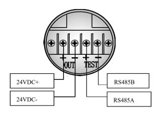
信号线可采用双绞线,在电磁干扰较严重的场合,建议使用屏蔽导线,并妥善接地。信号线不要与其它电源线一起穿金属管或放在同一线槽中,也不要在强电设备附近通过。变送器电气壳体上的穿线孔,应当密封或者塞住(用密封胶)以避免电气壳内潮气积聚。如果穿线孔不密封,则安装变送器时,应使穿线孔朝下,以便排除液体。
